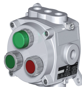
KNISB.2B1S/000.EX Botão Verde 1NA Botão Vermelho 1 NF Sinalizador Verde com LED (130 Vca/cc)
